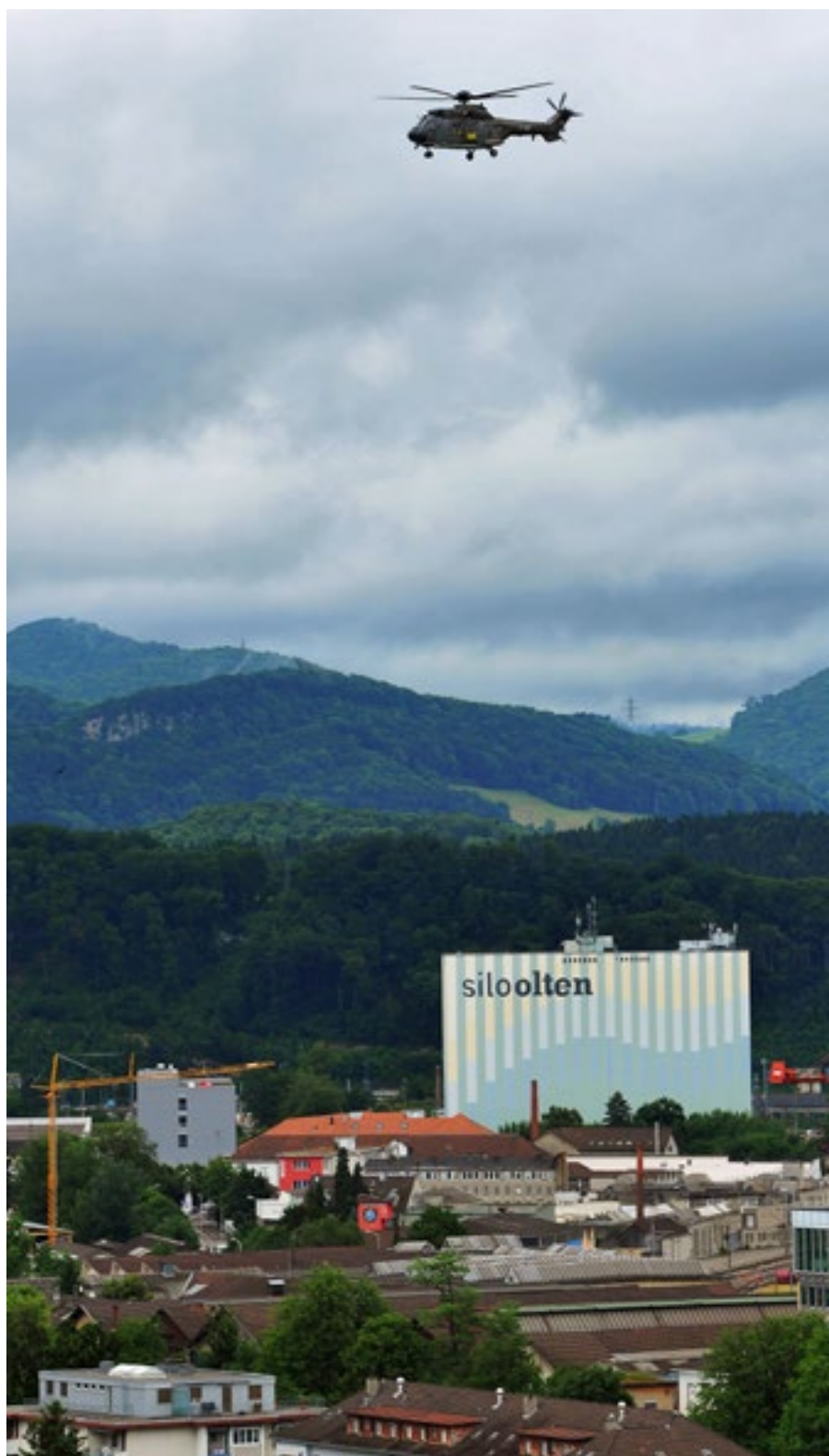
L'hélicoptère de mesure survolant les toits d'Olten. Les mesures au-dessus des villes visent la préparation à l'engagement: en cas d'événement, elles servent de mesure de référence pour détecter d'éventuels écarts par rapport à la normale.
